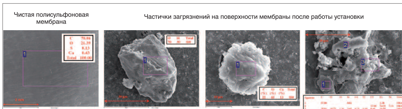
Рис. 2. Микрофотографии чистой (новой) мембраны и частиц на ее поверхности после фильтрации отработанного моющего раствора [2]
