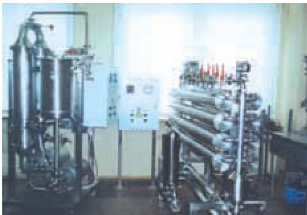
Рис. 3. Комплекс мембранного оборудования для микрофильтрации, ультра- и нанофильтрации для объемов сепарации 10 м 2 - 30 м 2 . Может быть использован, например, для удаления микрофлоры из обезжиренного молока и последующего его концентрирования). Состоит из микрофильтрационного модуля ММТ-4 с керамическими мембранами (4 м 2 ) и ультрафильтрационного модуля УМС-80 с рулонными мембранами (80 м 2 )
